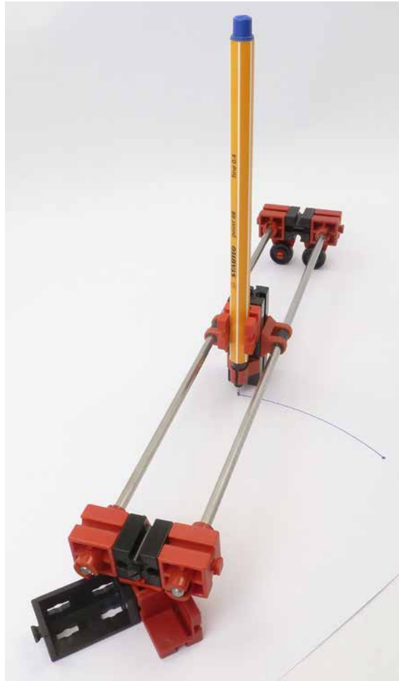
Abb. 1–23: Der fertige Stangenzirkel
